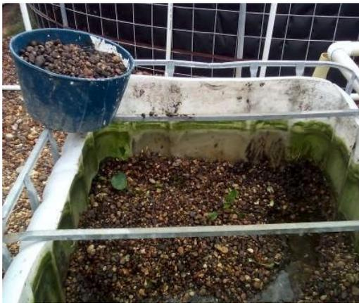
Fotografía 5. Desarme de filtro mecánico en sistema RAS
